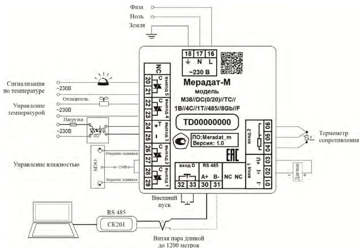
**Схемы.** Регулирование влажности с использованием электрозадвижки. регулирование температуры при помощи нагревателя ( $N>1.5$  кВт). Для измерения влажности используется датчик с выходным сигналом 0-20 мА, для измерения температуры – термометр сопротивления.
