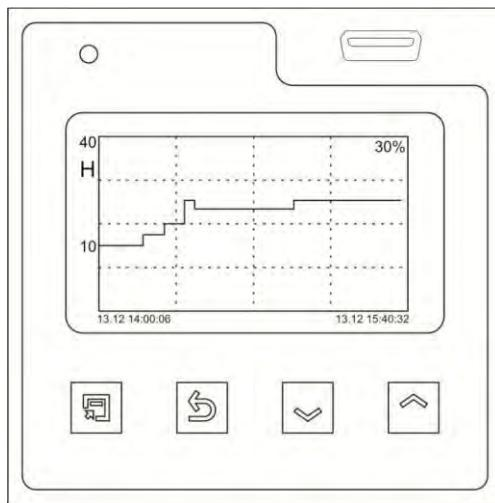
Переключение между графиком влажности и температуры происходит при нажатии на кнопку ↵. А при нажатиях на кнопки ⌄ или ⌅ происходит сдвиг графика вправо-влево.
